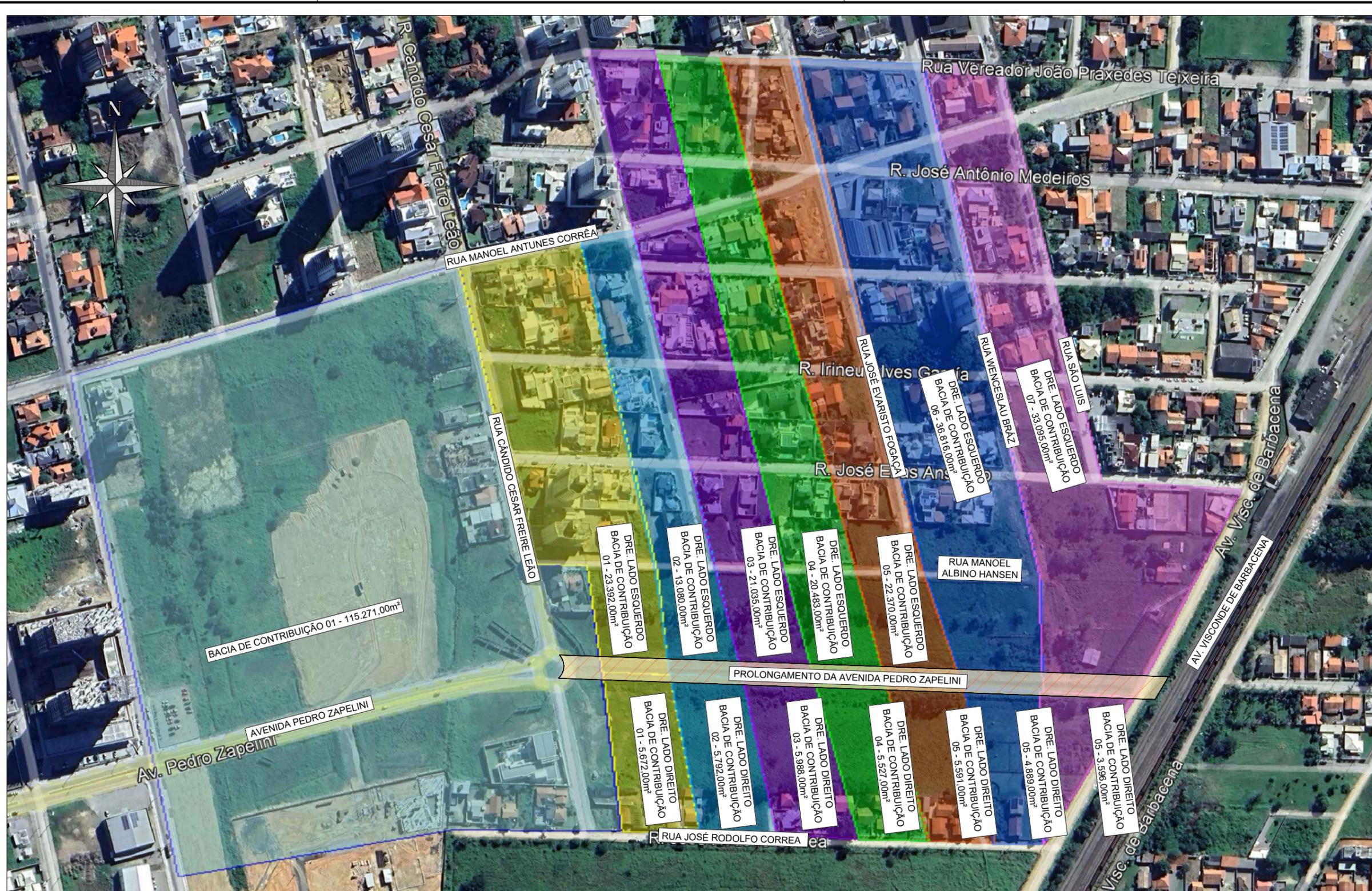
BACIAS DE CONTRIBUIÇÃO PARA DIMENSIONAMENTO DA DRENAGEM PLUVIAL SEM ESCALA
