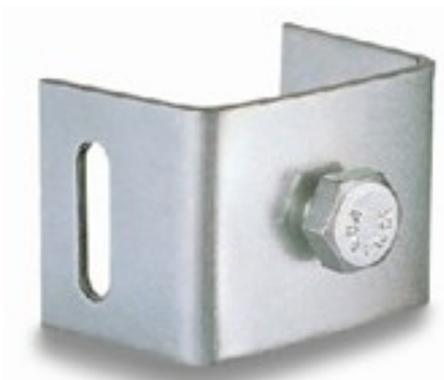
Castanha ou Braquete de aço inox 3/4, para fixação de placas com parafuso de 1/4, com rasgos laterais de 1" x 1/4". Parafuso de 1/4", comprimento total 1", com porca no próprio braquete e 2 arruela.
