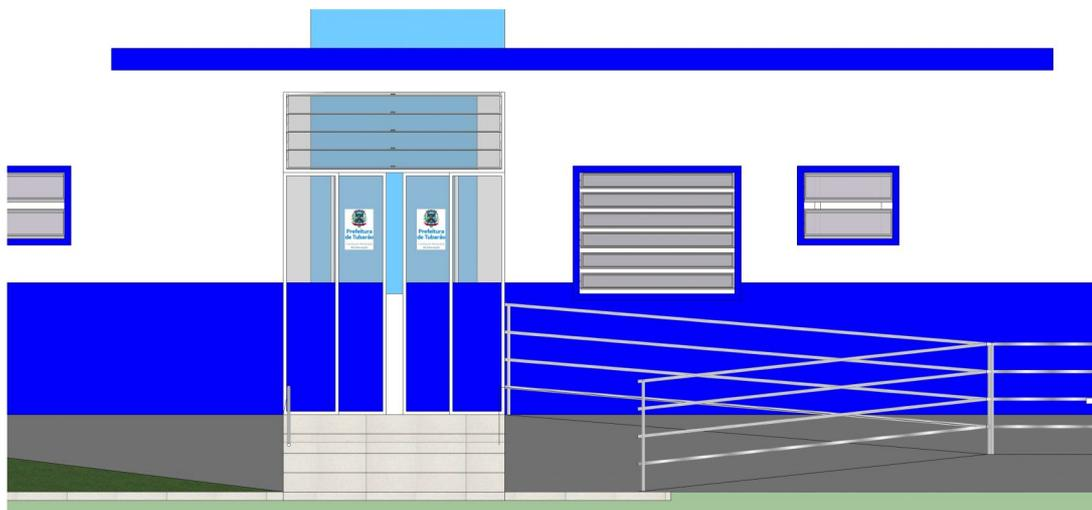
Porta plotada com parte superior da plotagem alinhada com a pintura, ambas faixa na cor azul.
