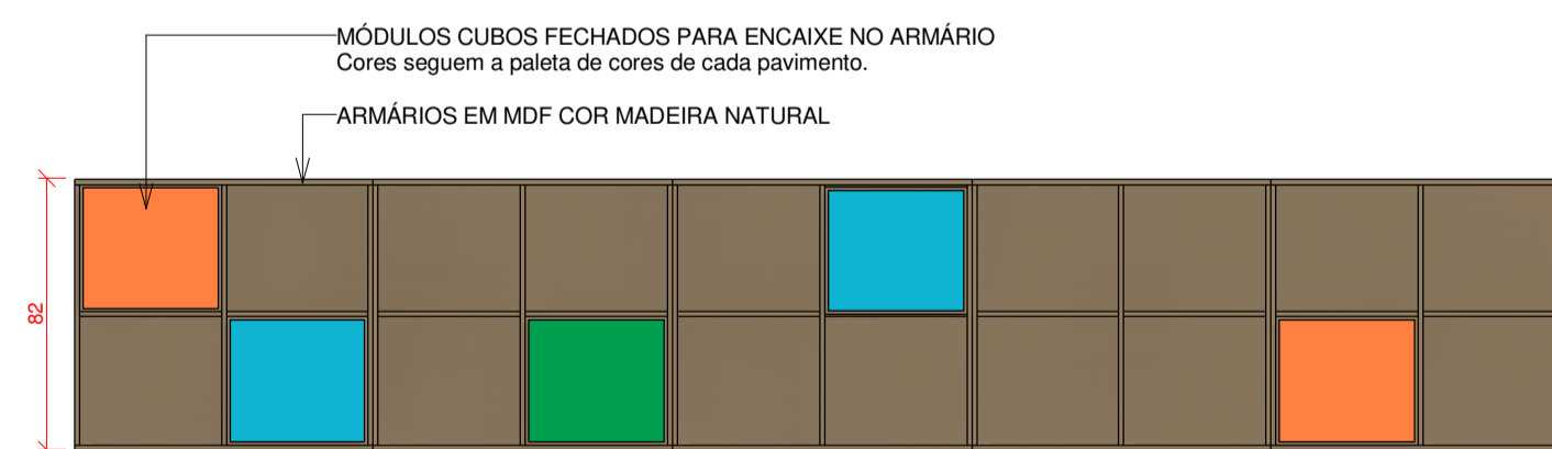
Armário em Módulos - Vista Frontal / Esc 1 : 25
