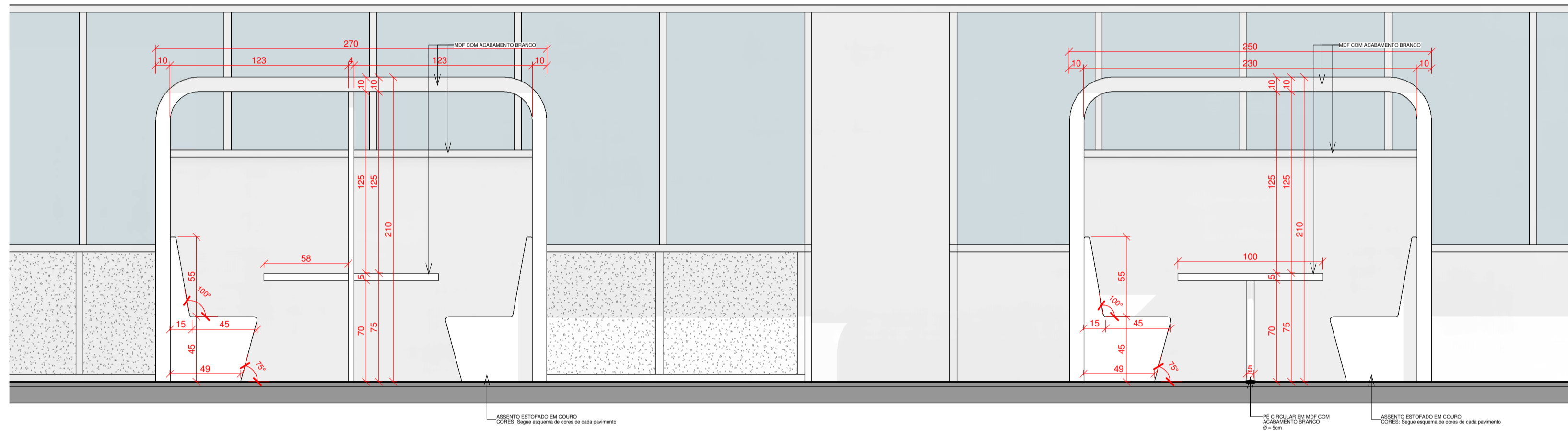
Estação de Trabalho - Vista Frontal / Esc 1 : 25
