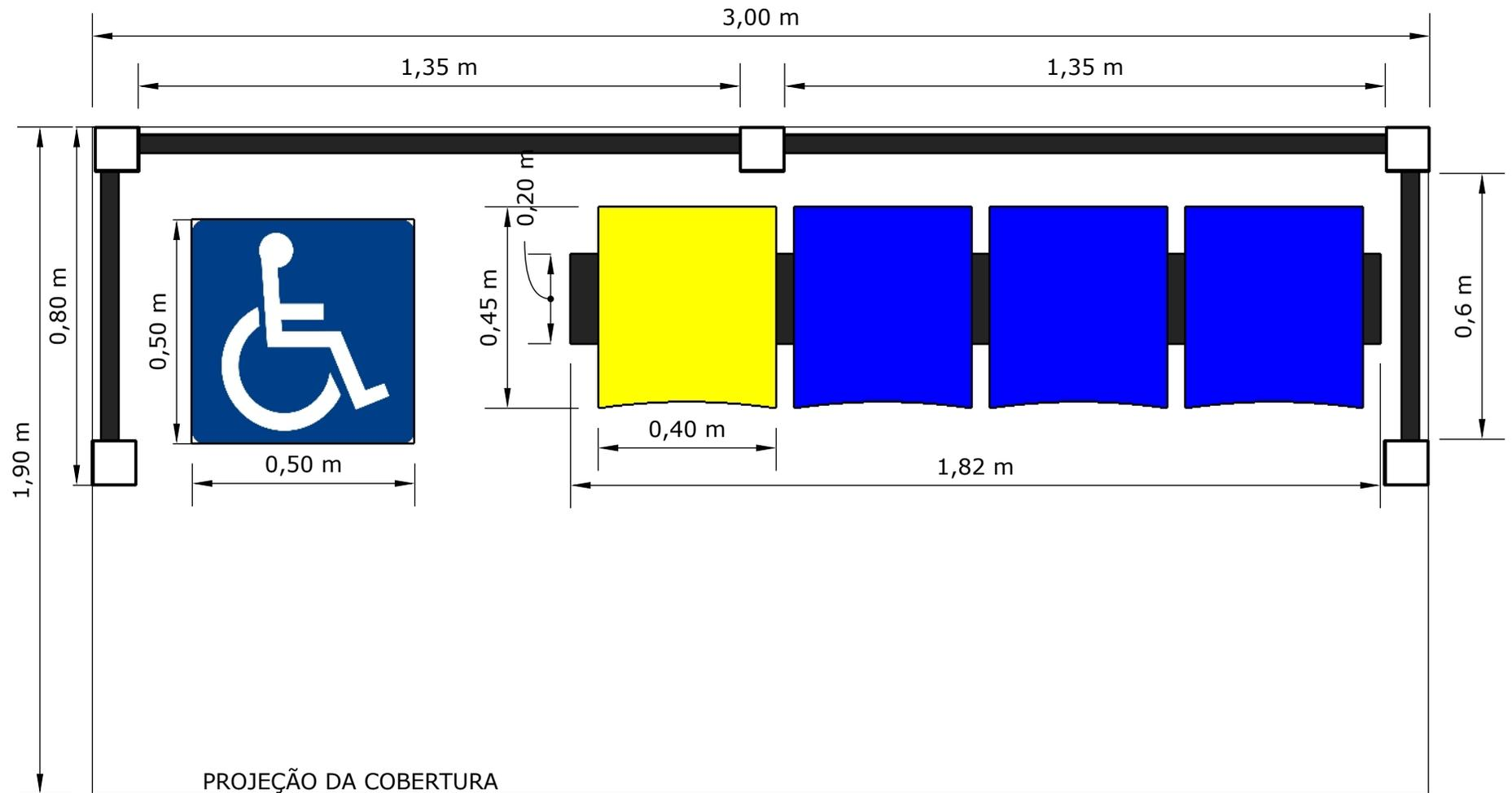
PLANTA BAIXA ABRIGO TIPO IV e TIPO V
